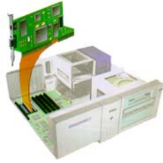
รูปแสดงการติดตั้งโมเด็มภายในเครื่อง (Internal MODEM)
